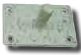
Feuerverzinkt 55 µm Nach 408 Stunden
