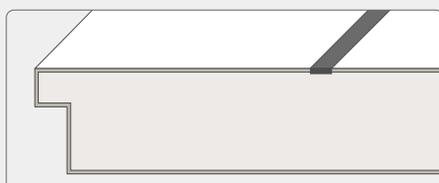
Der in verschiedenen Oberflächen erhältliche Lines-Plan-Keder wird in das Türblatt eingelegt.
