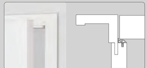
Bei der stumpfen Ausführung bildet das Türblatt eine annähernd bündige Ebene mit der Bekleidung.
