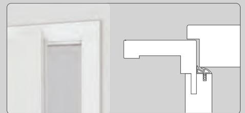
Bei der gefälzten Ausführung liegt das Türblatt auf der Bekleidung auf.
