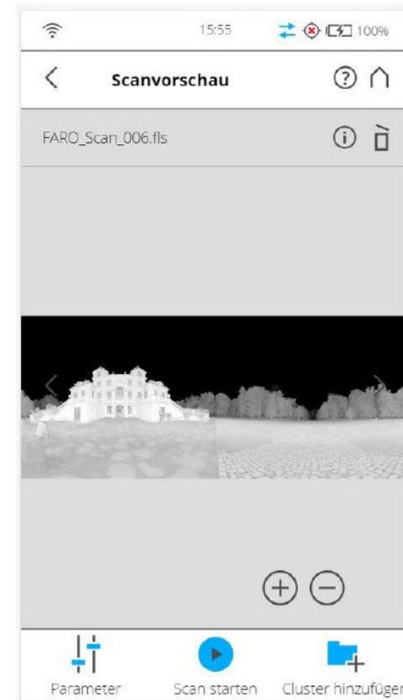
Mit einem Druck auf die Start Taste wird der Scanvorgang gestartet.
