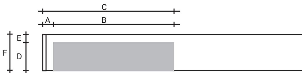
Wichtig: Maß A immer vom hintersten Teil des Abschlusses messen, der am Blendrahmen des Fensters bei der Montage anliegt. Bei Abschlüssen mit Dichtstück: Maßangabe inkl. Dichtstück!
