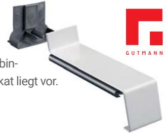
Stoßverbinder lose, mit einer EPDM-Dichtung und passendem Dichtstück ausgestattet. Eine optimale Verbindung gewährleistet Dehnungsausgleich und erzielt hohe Schlagregendichtheit. Systemprüfung mit Zertifikat liegt vor.
