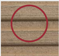
natürlicher Fasereinschluss nach mechanischer Behandlung
