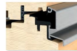
3 Dichtebenen und entlüftete Anschlussecken an der thermisch getrennten Regenschiene. Das ist konstruktiver Holzschutz.
