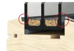
Der luftdichte Glasanschluss ist nicht nur zum Flügelholz und zur Aluschale dicht, sondern zusätzlich noch elastisch an die Glasleiste abgesiegelt.
